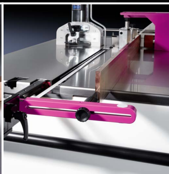
Резка токовых шин с помощью встроенного прецизионного лазера
