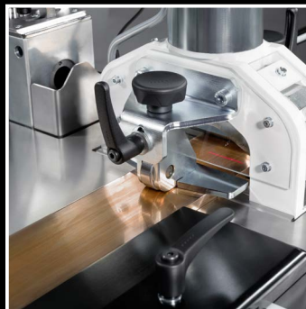
Гибка токовых шин
